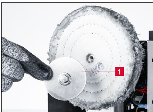
Figure 7-19 Retirer la vis et la bride de serrage (7-19/1).
