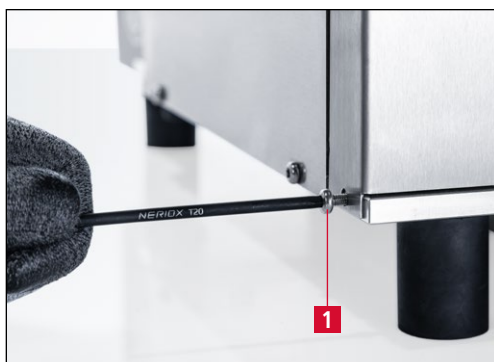
Figure 7-16 Desserrer le capot du disque de polissage
