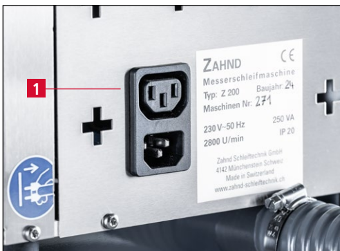
Bild 7-23 Anschluss für Industriestaubsauger
