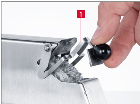
Bild 7-4 Führungsbügel nach oben klappen
