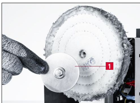
Bild 7-19 Spannschraube und Spannflansch abnehmen
