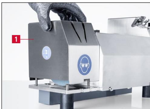
Figure 7-11 Retirer le capot de protection
