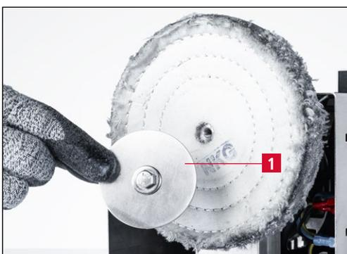
**Figure 7-19** Retirer la vis et la bride de serrage
