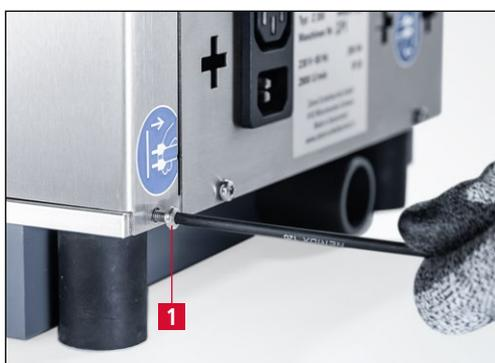
**Figure 7-15** Desserrer le capot du disque de polissage
