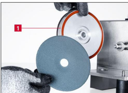
Figure 7-14 Monter une nouvelle paire de meules
