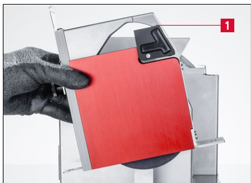
Figure 7-9 Retirer l'unité guide-lame
