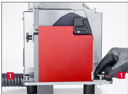
Figure 7-8 Desserrer les vis moletées de l'unité guide-lame
