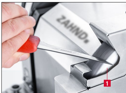
Figure 7-6 Démorfiler et polir un couteau à main
