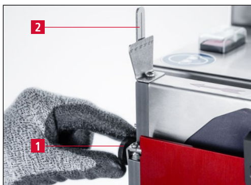
Figure 7-2 Réglage de l'angle d'affûtage
