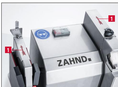
Figure 6-2 Vérifier le sens de rotation
