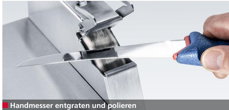
Die Z 200 macht das Messerschärfen so einfach wie nie. Dank der präzisen Führung wird das Messer sowohl beim Schleifen als auch beim Polieren im optimalen Winkel gehalten – für ein müheloses, sicheres und perfektes schleifen.
