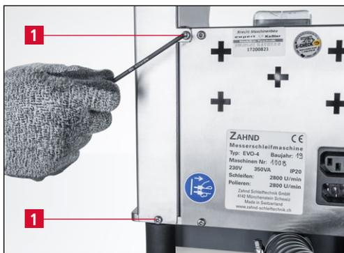
**Bild 7-13** Polierscheibenabdeckung hinten lösen
