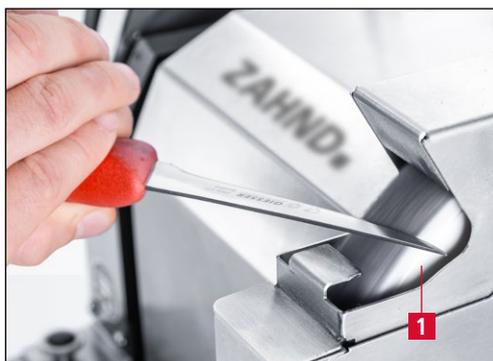
Bild 7-6 Handmesser entgraten und polieren
