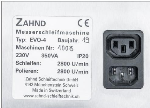
**Bild 1-1** Typenschild und Maschinenummer
