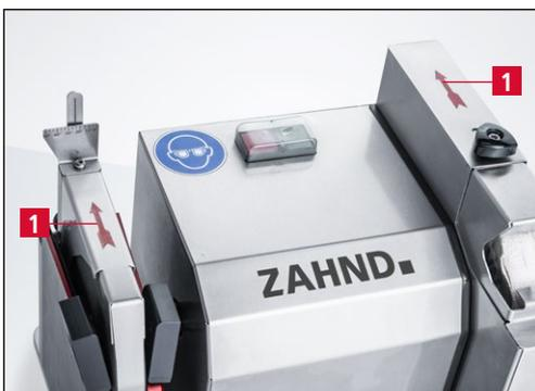
Bild 6-2 Drehrichtung prüfen
