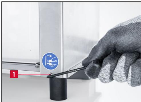
**Bild 7-14** Polierscheibenabdeckung vorne lösen
