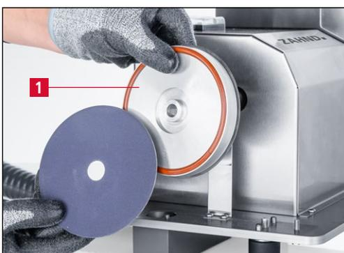
**Bild 7-12** Neues Schleifscheibenpaar montieren
