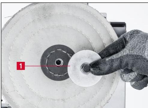
**Bild 7-17** Spannflansch abnehmen
